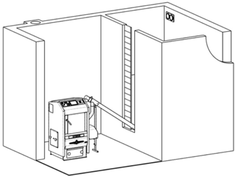
Für optimales Zusammenschütten von Pellets muss der Winkel der Innenwände im Pelletsbehälter mindestens  $45^\circ$  betragen. Alle Wände werden in den niedrigsten Punkt des Pelletsbehälters gerichtet, von dem die Pellets mit der Förderschnecke geschöpft werden.
