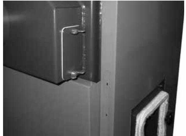
Steckverbindungen in der linken Kesselabdeckung
