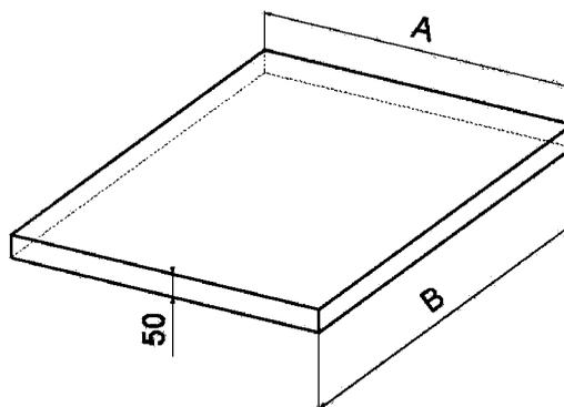
Es wird empfohlen unter den Kessel Beton-/Stahlfundament zu fertigen.
