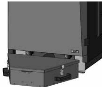
Bei vollständiger Auffüllung des Zusatzaschekastens kommt automatisch zum Abstellen der Entschungsanlage (Schnecke) und der Entschungsmodul beginnt akustisches Signal auszugeben. Neue Inbetriebsetzung wird nach der Reinigung des externen Aschekastens (Austragen) mit bloßer Ausschaltung und Einschaltung des Schalters /20 (15)/ am Kessel für 5 sec, durchgeführt.
