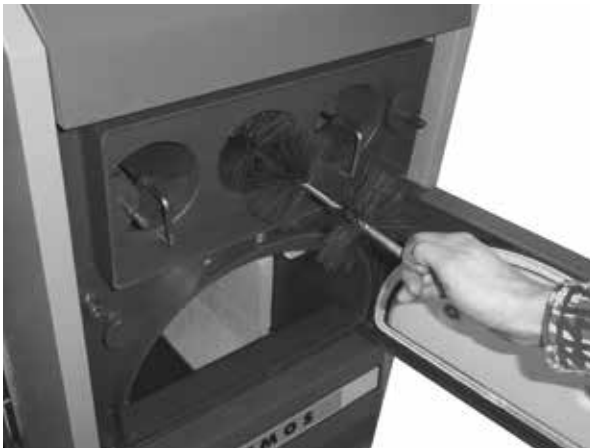
Reinigung des Wärmetauschers (Rohrwand) mit der beigefügten Bürste (bei den Kesseln P20, P30, P40, P50)
