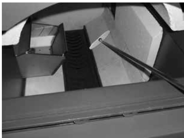
Zusammenkehren der Asche über das Gitter in den unteren Raum (Ascher)
