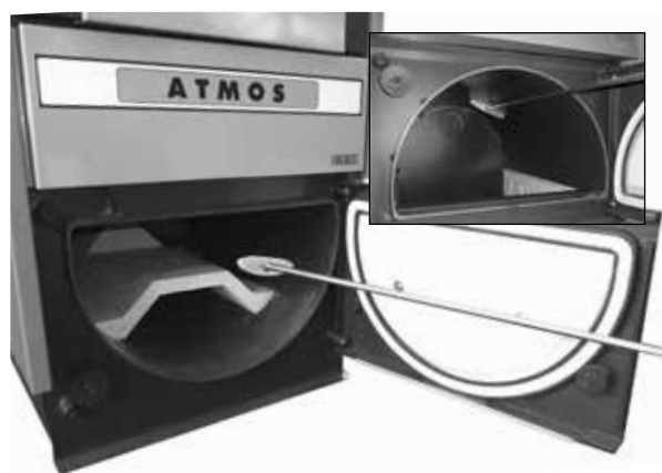
Geöffneter Unterraum des Kessels mit Dach und mit Vorführung der Ascheentleerung mittels Schürhakens
