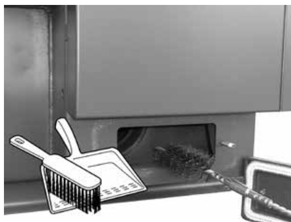
Vorführung der Reinigung des Rauchkanals mit Drahtbürste.
