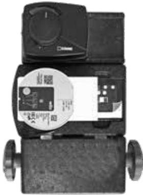
Die vorgeschriebene Lösung für die Haltung der minimalen Rücklauf-temperatur (65 - 75 °C) ist eine Mischbaugruppe ESBE (Pumpengruppen mit Rücklaufregelung GRA111) mit einem Servoantrieb ESBE ARA (60 s), der durch den Regler ACD 04 gesteuert ist.
