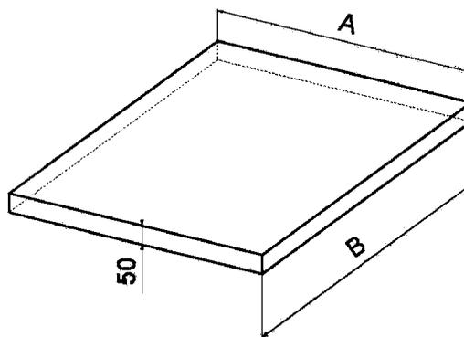
Wir empfehlen unter dem Kessel ein Beton-(Metall-)Fundament zu errichten.
